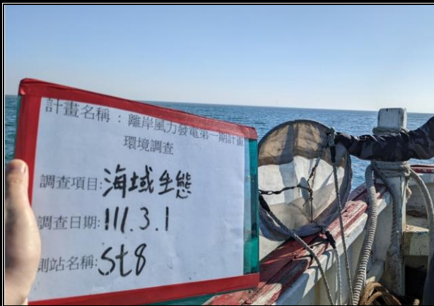
日期：111年3月1日 地點：海域生態測站-ST8 說明：浮游動物、仔稚魚及魚卵採樣
