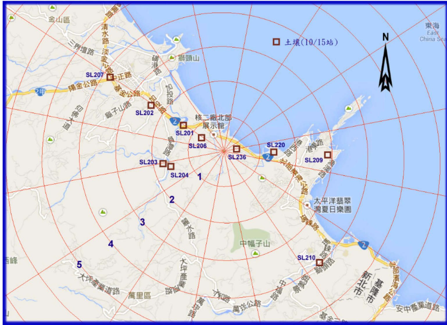
圖 9 核能二廠土壤取樣站分佈圖(5 公里內)
